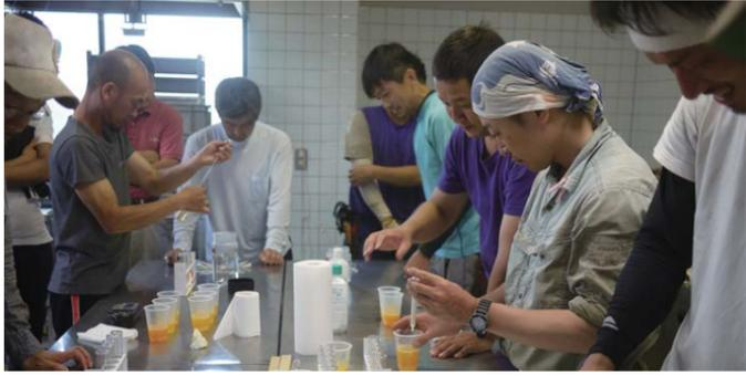
果物の品質を決める尺度の一つに Brix（ブリックス）があります。いわゆる「糖度」のことで、果汁中にどれくらいショ糖や果糖などの糖が含まれているのかを測る尺度です。Brix≒糖度を測るには、果汁に含まれる糖の量によって光の屈折率が違う性質を利用した糖度計を用います。昔は万華鏡のように窓を覗き込んで目盛りを読むアナログの糖度計でしたが、最近はより手軽なデジタル糖度計を使うようになってきました。果汁を測定器に落としてボタンを押すだけで糖度をはじき出してくれます。
