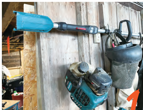
草刈り機の動力部分。エンジン式（下）と電動式（上・バッテリー未装着）。電動式は小型軽量で扱いやすいですが、パワーはまだエンジン式に軍配が上がるかな。
