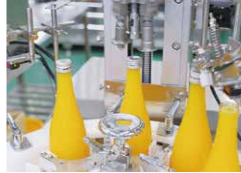
アルミキャップをかぶせて瓶の溝に合わせ、加工する
